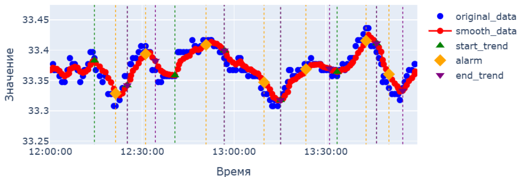
Рис. 2. CUSUM алгоритм со сглаживанием через фильтр Калмана
